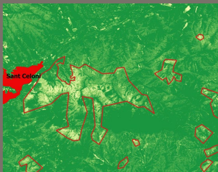
Montseny. Diferència entre els NDVI de les imatges del 9 de març de 2019 i del 27 de juny de 2019. Els tons més clars representen zones on hi ha hagut canvis (defoliacions) i els tons verdosos representen zones sense canvis, és a dir, sense afectació.
